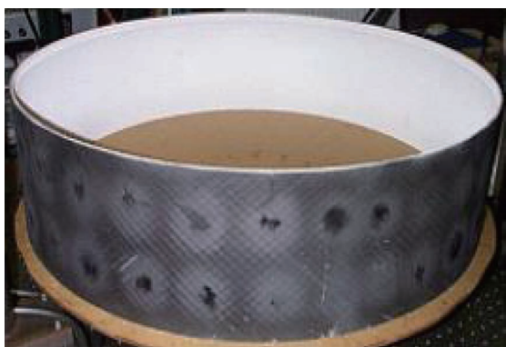
图7 氧化物/氧化物陶瓷基复合材料火焰筒
